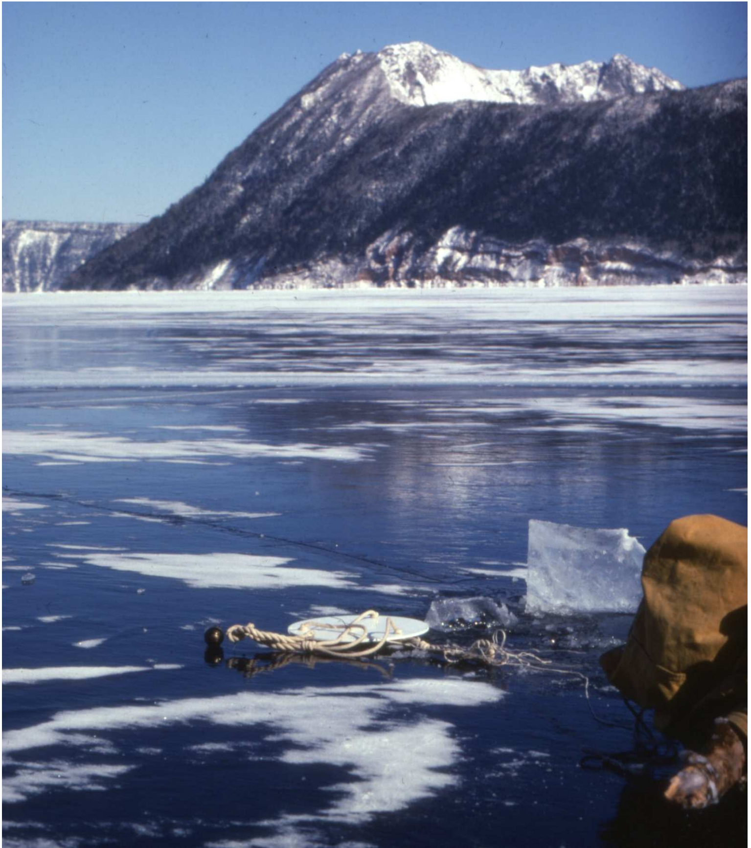
写真 128. 摩周湖での透明度測定と氷サンプル採取(摩周湖、2 月)。 白い板は透明度測定用の標識。摩周湖はバイカル湖と並んで透明度 の高い湖の一つであり、1931 年に 41.6m の世界一の透明度記録を持 ち、この記録は現在も破られていない。
