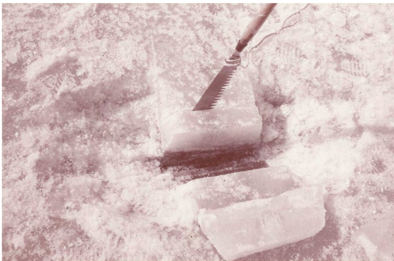
写真 147. 前の写真の氷紋における腕(水路)の断面観測 (春採湖、2 月)
